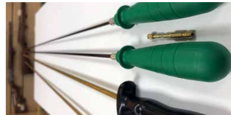
Putzstöcke, heute auch aus Carbon gefertigt. Leicht, stabil und laufschonend.
